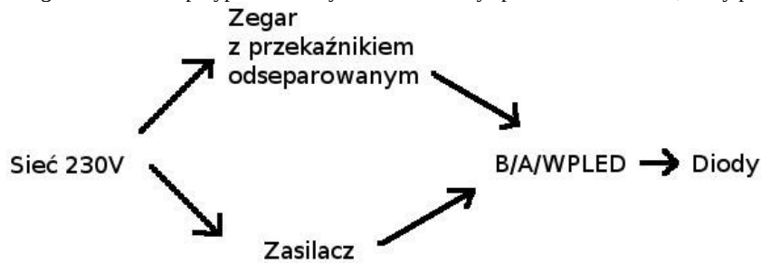
Rys. 9. Idea połączenia układu z zegarem czasowym.
